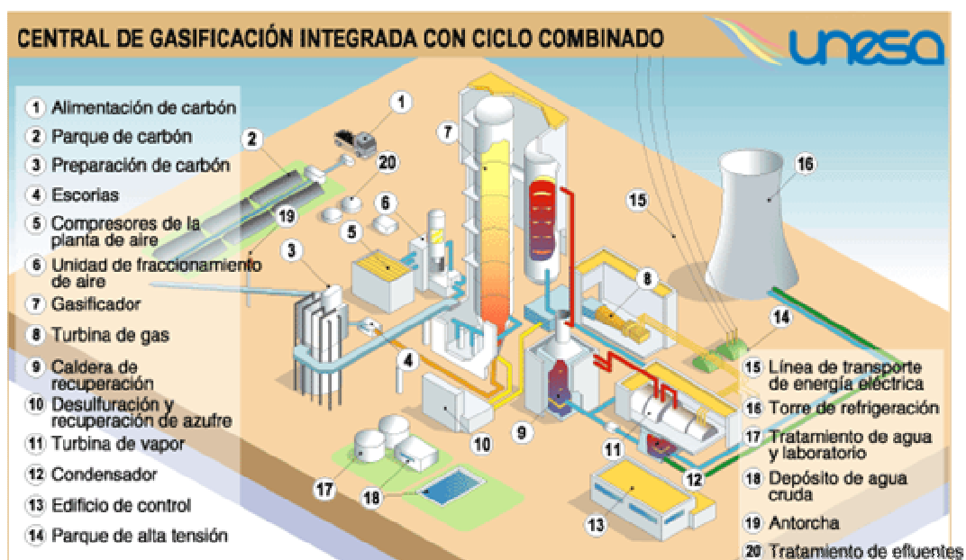
Figura 2-4. Central de gasificación integrada con ciclo combinado.
