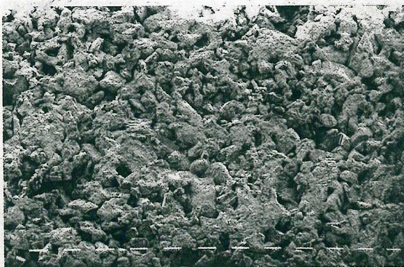
Fig. 18.—Aspecto de la textura. Pueden observarse los distintos tipos de granos, así como los espacios vacíos intergranulares. (M.E.B., 1 marcador = 100 \mu\text{m} ).
