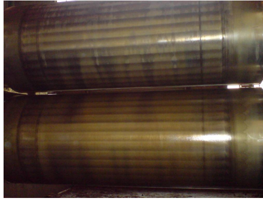
Figura 5.11: Marcas periódicas sobre cilindros de trabajo que ocasionaron una frecuencia en la banda del chatter (pertenecientes a un tren de laminación en caliente)[35].
