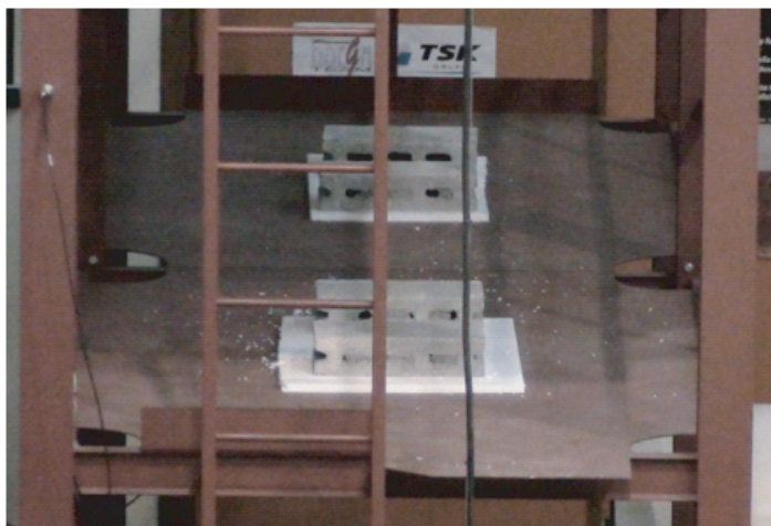
Figura 7.12: Masas de hormigón colocadas en una de las plantas de la estructura.
