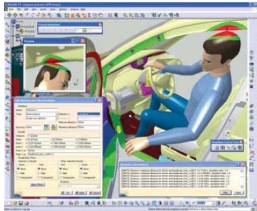
Figura 2.2. Ejemplo de software de simulación en coche-conductor-cambio de marcha ( Ergonomics DELMIA )
