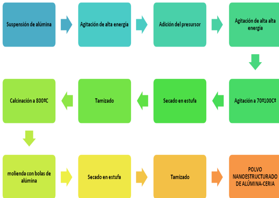
Figura 40. Esquema de preparación del polvo nanoestructurado de alúmina-ceria.
