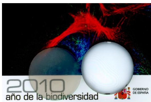
Figura 66. Comparación de la alúmina-ceria transparente (Izda) sinterizada por SPS con alúmina sin dopar sinterizada por SPS.
