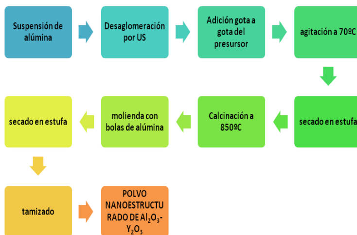
Figura 70. Esquema del dopaje coloidal con alcóxidos.
