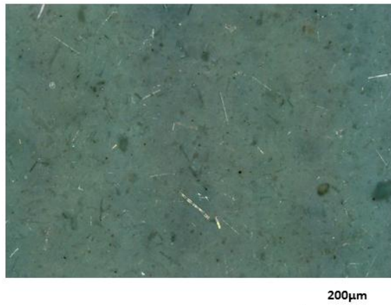
Figura 136. Imágenes de microscopía óptica de la distribución de las fibras de alúmina en el cuerpo en verde.
