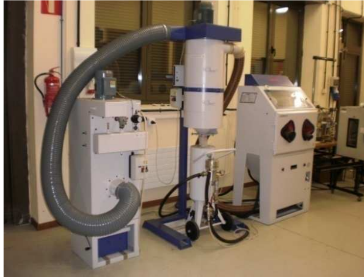
Figura 4.1 Equipo de shot peening utilizado
