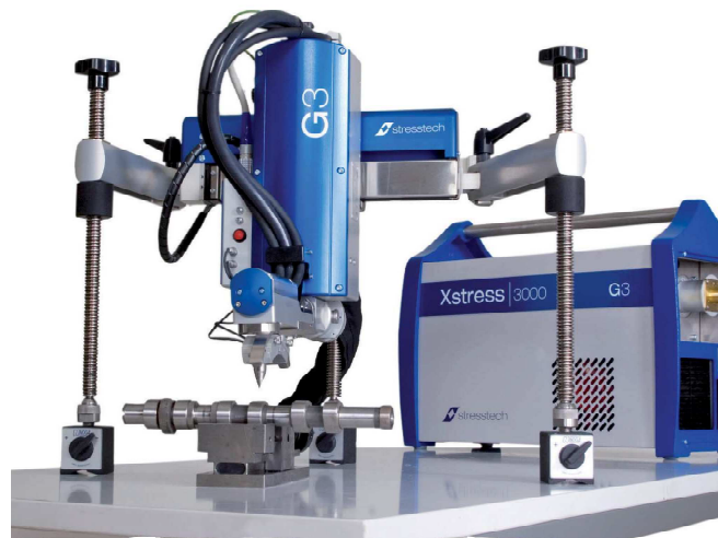
Figura 4.14 Difractómetro utilizado para la medida de tensiones residuales
