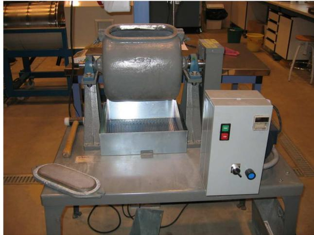
Foto 1.- Molino de Bond utilizado en Laboratorio de Tecnología Mineralúrgica de la Escuela Politécnica de Mieres.
