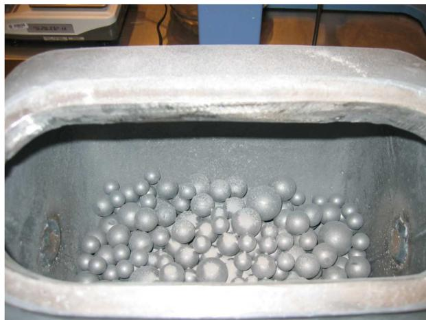
Foto 3.- Carga molturante del molino.
