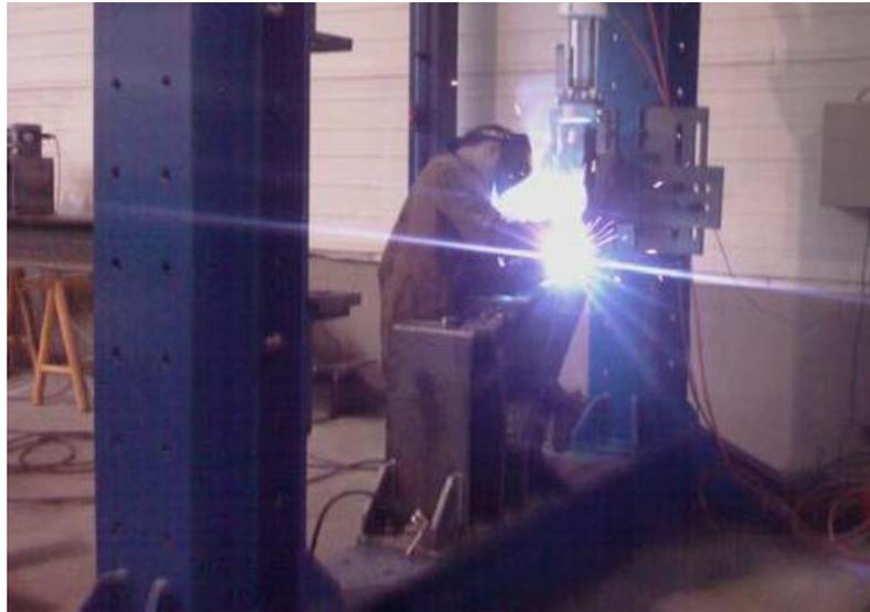
Figura 4.25 Punteado de las barras de relleno para conformar la estructura del nudo en K
