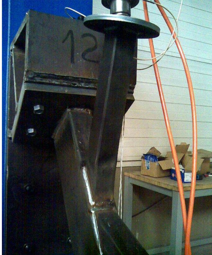
Figura 4.43 Fallo de la unión por inestabilidad fuera del plano de la barra de relleno
