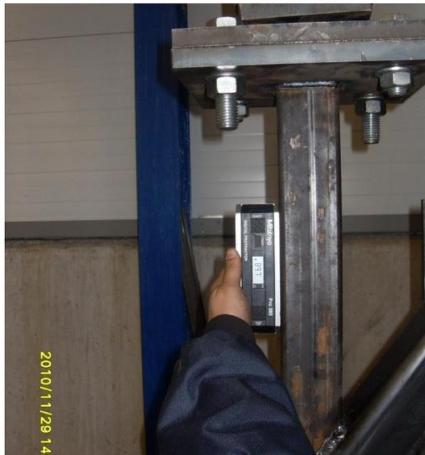
Figura 4.26 Alineación barra de relleno a compresión – célula de carga
