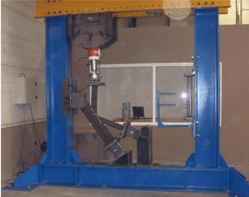
Figura 4.10 Configuración del marco para nudos con barras a 35°
