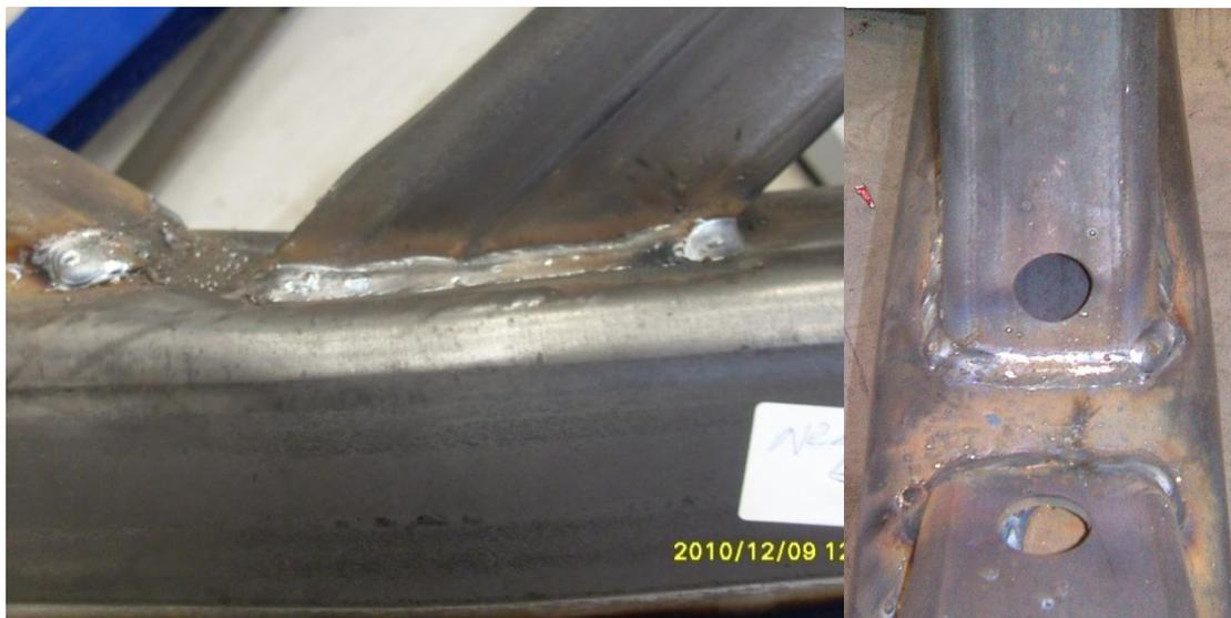
Figura 4.68 Ensayos 20 y 25 sobre el nudo KGP16 tras el fallo (barras de relleno con/sin agujeros)
