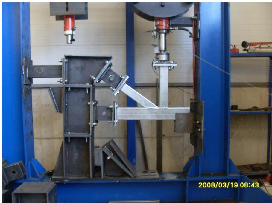
Figura 4.13 Configuración del marco para nudos con barras en N
