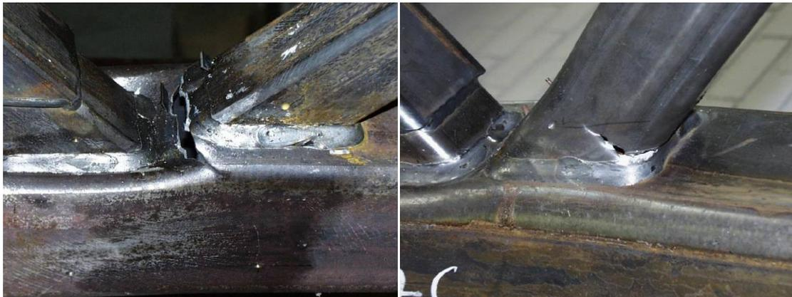
Figura 2.4 Fallo de uniones en K por ‘punzonamiento de la cara del cordón’ y por ‘anchura eficaz en la barra de relleno’ respectivamente
