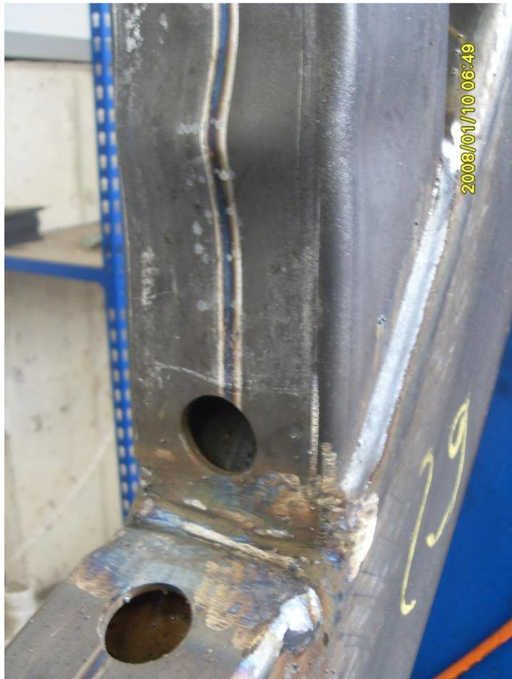
Figura 7.3 Inestabilidad localizada en una de las caras de la barra de relleno a compresión
