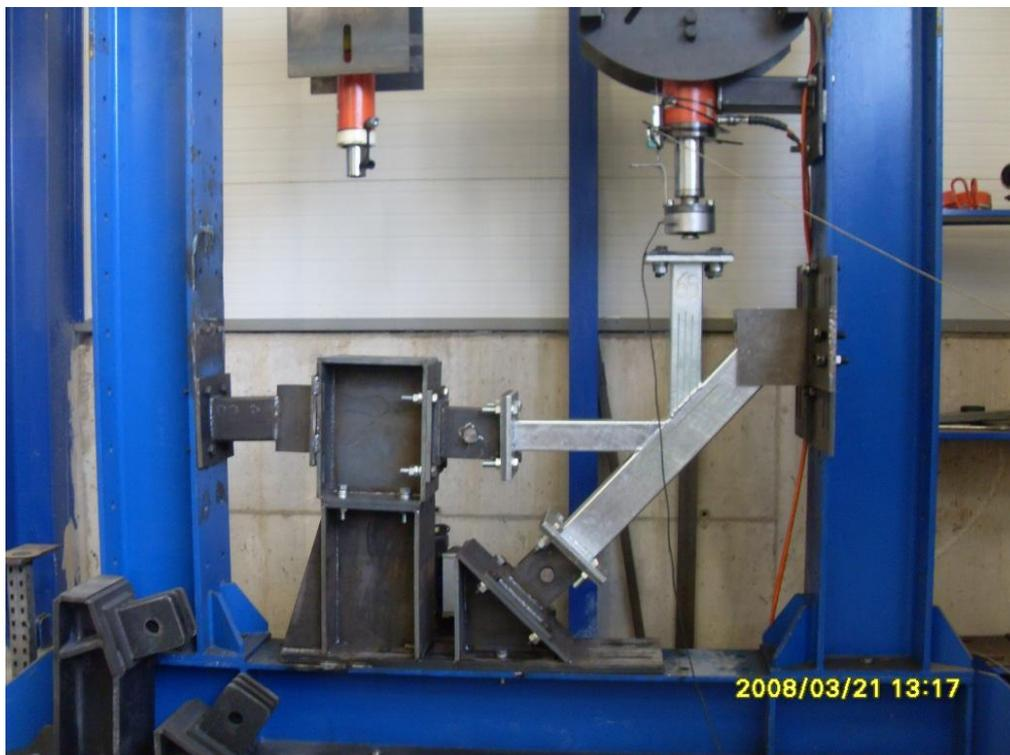
Figura 4.11 Configuración del marco para nudos con barras a 45°
