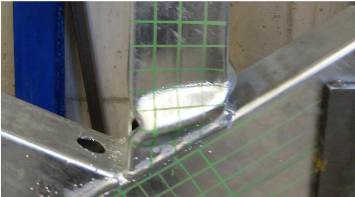
Figura 7.5 Inestabilidad localizada en las cuatro caras de la barra de relleno a compresión
