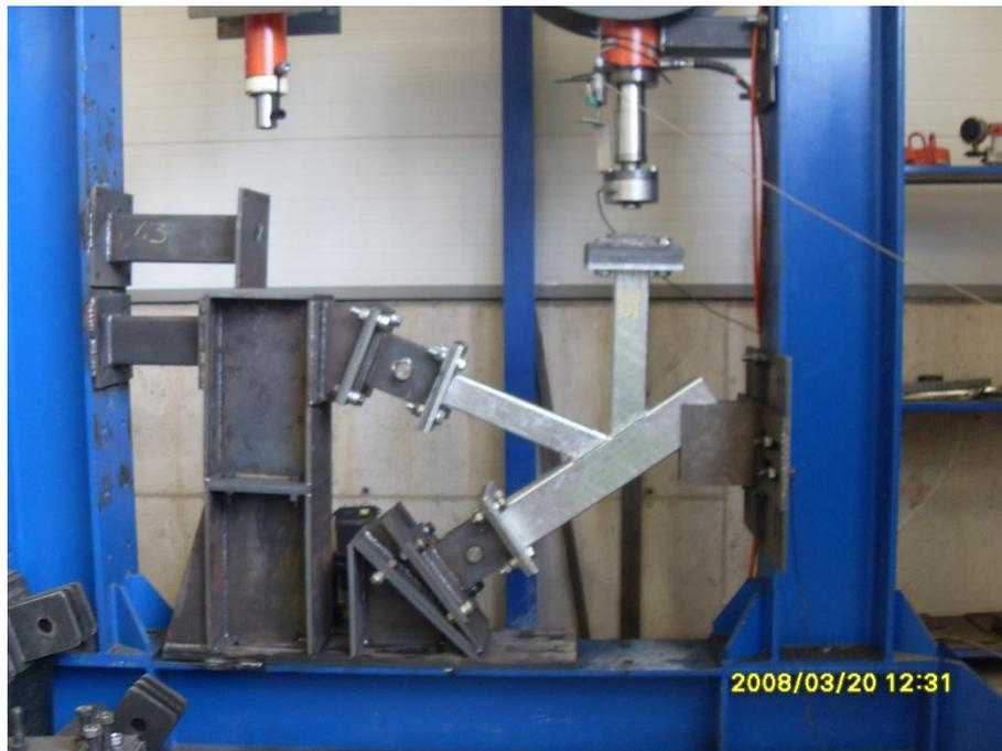
Figura 4.12 Configuración del marco para nudos con barras a  $55^\circ$
