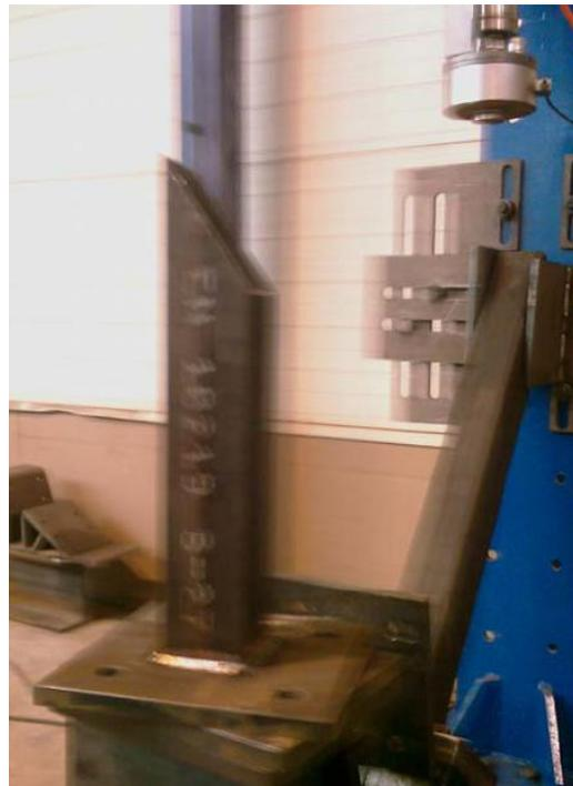
Figura 4.24 Barra de relleno a tracción lista para ser atornillada al banco de ensayos
