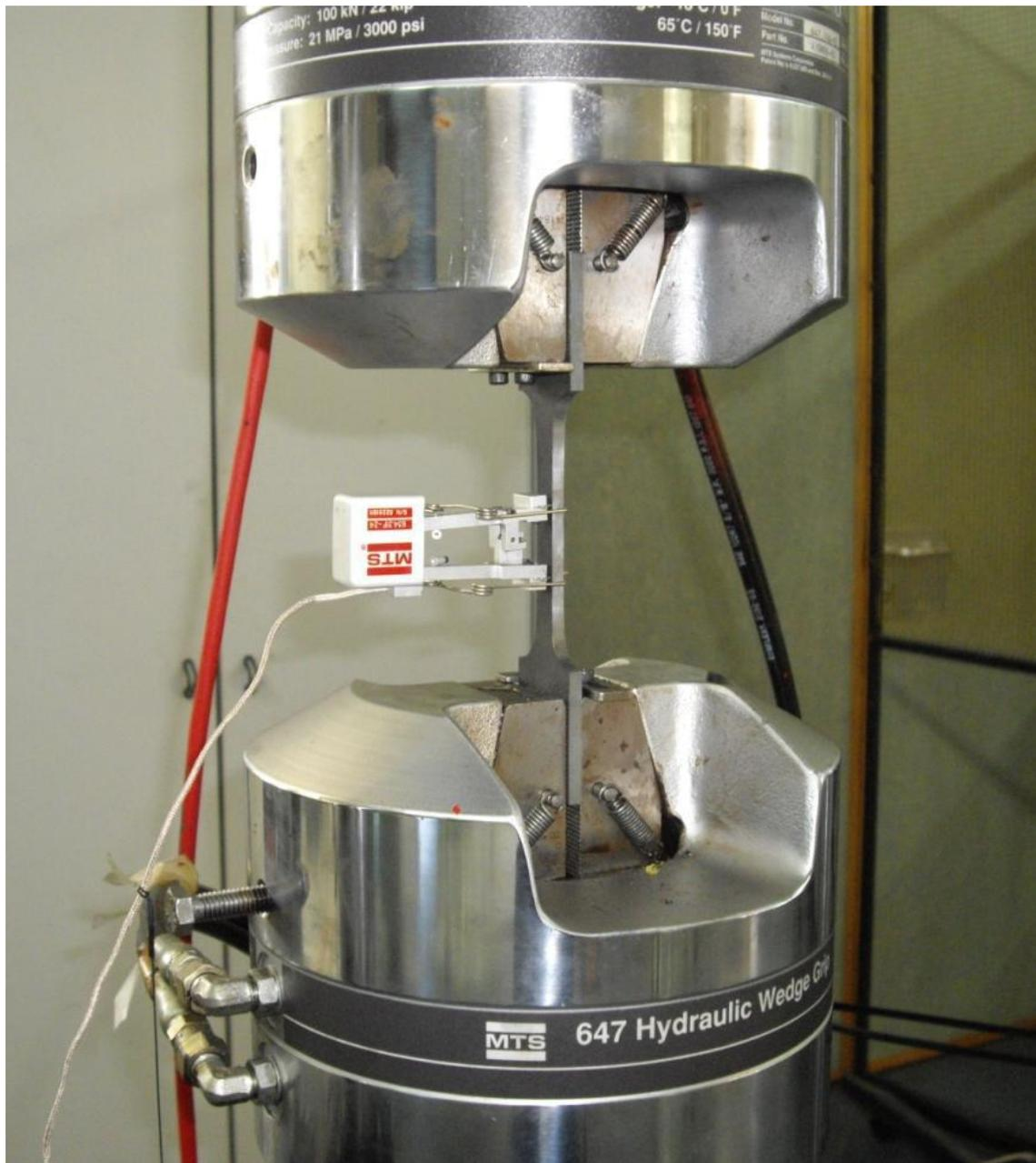
Figura 4.32 Detalle del ensayo de tracción
