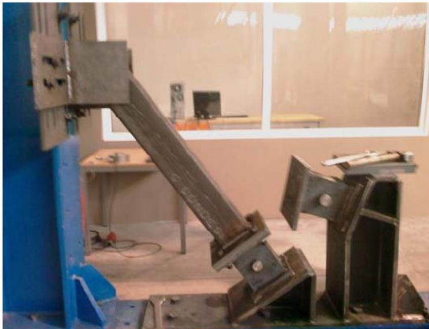
Figura 4.22 Colocación del cordón en el banco de ensayos
