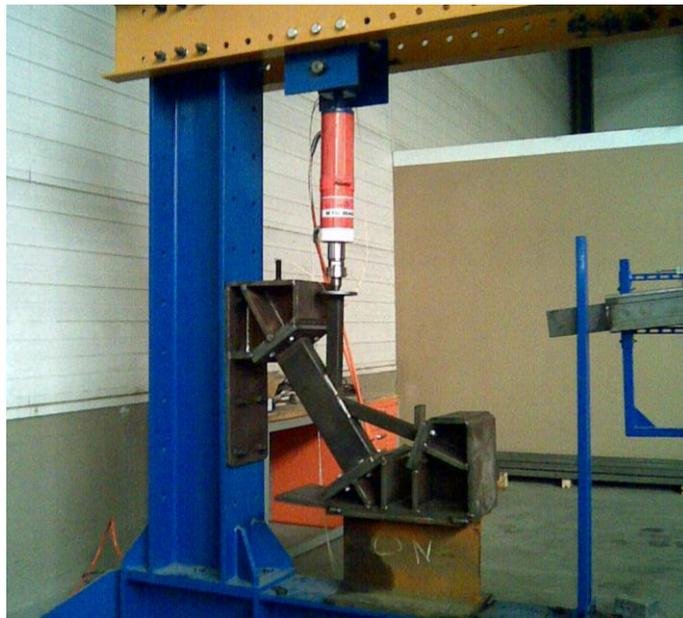
Figura 4.42 Configuración de prueba en los primeros nudos ensayados
