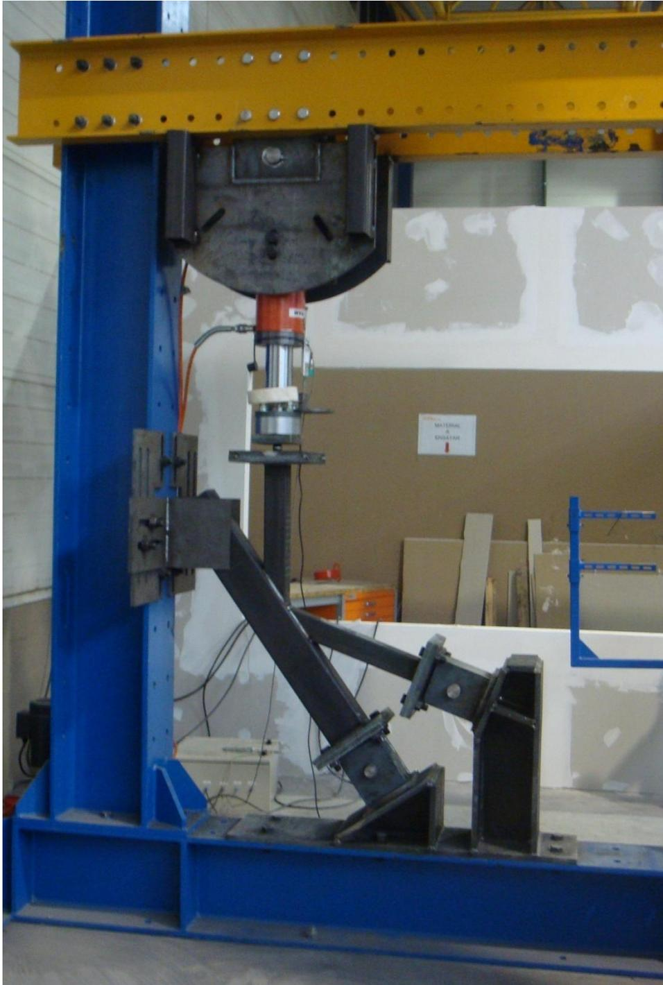
Figura 4.16 Configuración definitiva del banco de ensayos
