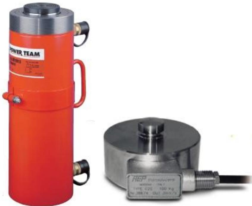
Figura 4.6 Actuador y célula de carga implementados en el banco de ensayos
