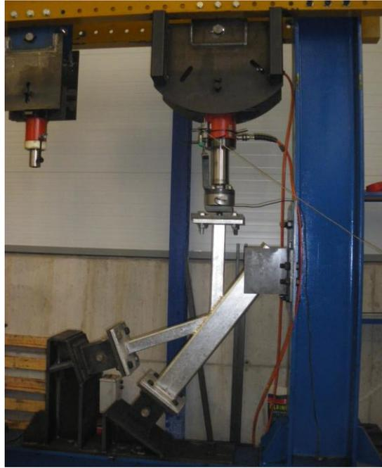
Figura 4.44 Configuración definitiva de los nudos en el banco de ensayos
