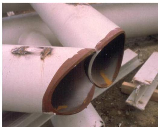
Figura 1.21 Preparación de extremos para una unión en K con recubrimiento entre perfiles CHS
