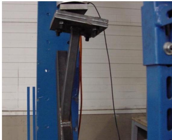
Figura 4.15 Fallo fuera del plano de la unión registrado en el primer ensayo de calibración del banco de ensayos
