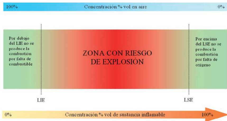
Figura 5. Zona con riesgo de explosión 1
