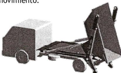
5. Colocar el contenedor vacío sobre la plataforma
