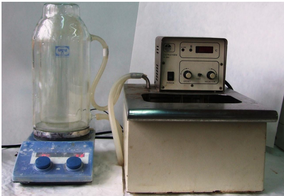
Figura 9. Reactor empleado para la hidrólisis química.
