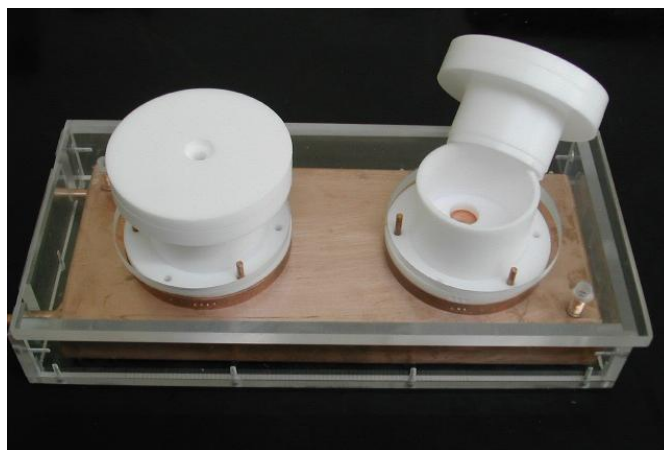
Figura 28: Celdas de anodización electroquímica sobre la placa de cobre que forma parte del sistema de refrigeración.
