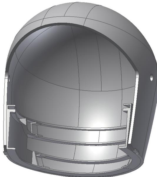
Ilustración 86 Bloque monocasco que incluye parte del sistema resistente de protección
