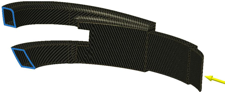
Ilustración 88 Modelo de la propuesta definitiva, empotrada en su extremo posterior, con toda la carga aplicada en el extremo frontal
