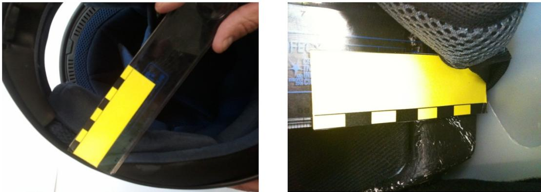
Ilustración 53 Espesor del relleno de protección en dos modelos de casco.
