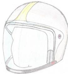
**2** La energía de impacto se transmite al casco por el desplazamiento o deformación del visor y la barra de refuerzo dispuesta en su parte inferior.
