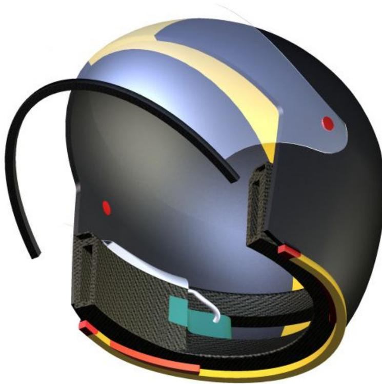
Ilustración 113 Casco de tipo abierto con sistema de protección integral con los sistemas expuestos, sin relleno
