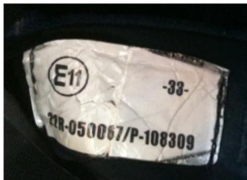
Ilustración 7 Marcado de un casco comercial según ECE R22-05. La letra P indica que protege la zona mandibular.
