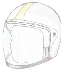
**2** La energía de impacto se transmite al casco por el desplazamiento o deformación del visor y la barra de refuerzo dispuesta en su parte inferior.
