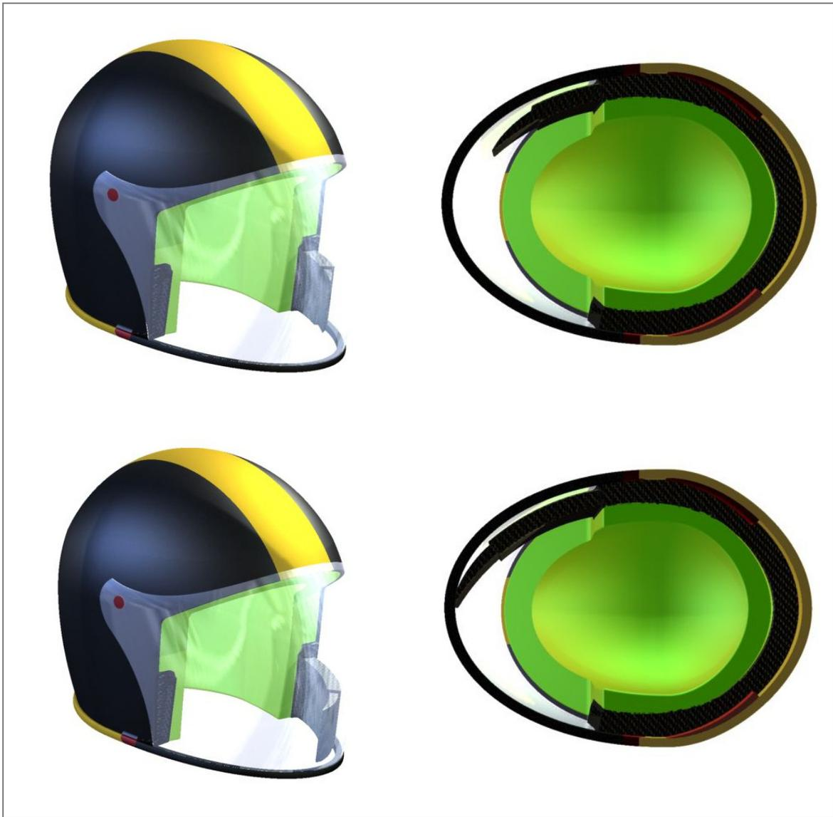
Ilustración 115 Secuencia de despliegue del sistema estructural de protección (no se muestra la bolsa inflable)
