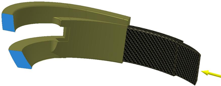
Ilustración 64 Modelo del prototipo, empotrado en su extremo posterior, con toda la carga aplicada en el extremo frontal
