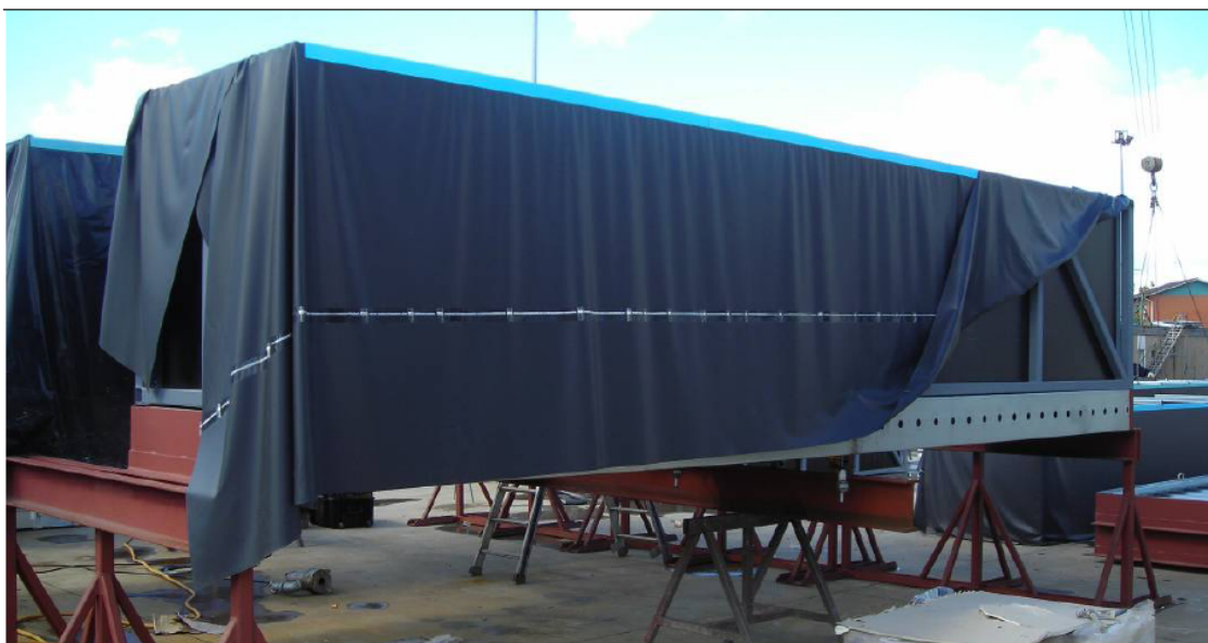
Figura 104- Ensayo de forjado. Balsa, forjado y caballetes.
