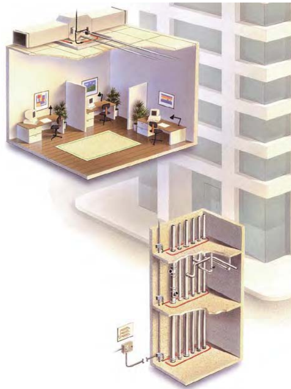
Figura 75.- Control de fugas mediante cables
