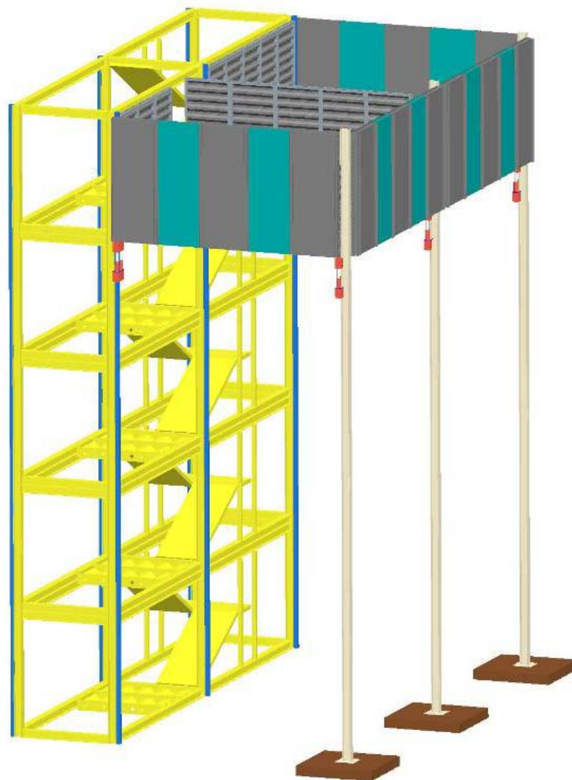
Figura 181. - Riesgo de colapso de los pilares por pandeo
