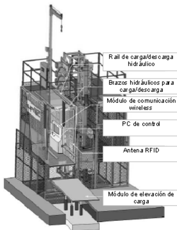
Figura 83.- Sistema de elevación automático
