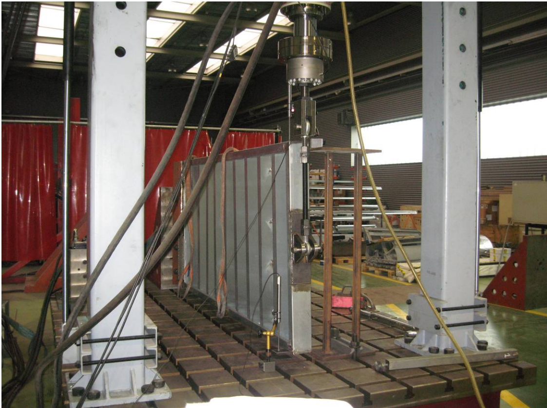
Figura 50.- Ensayo de tracción realizado al componente con equipamiento del proyecto
