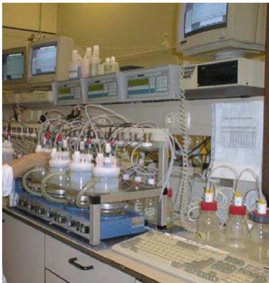
**Figura 5.2.** *Dispositivo experimental en el que se llevaron a cabo los experimentos de lixiviación a pH fijo para RPI y RPI-Hg (Energy Research Centre of the Netherlands).*
