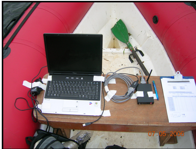
Foto 6. Equipamiento necesario para la medición de gases durante los test, instalado en una embarcación neumática.
