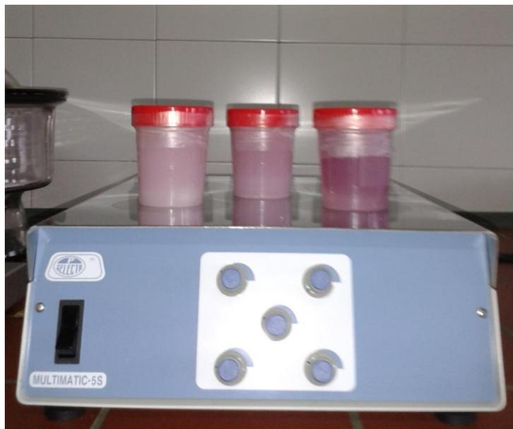
**Figura 2.1:** Experimentos de envejecimiento por triplicado. El color morado es debido al ión  $\text{Co}^{2+}$ .
