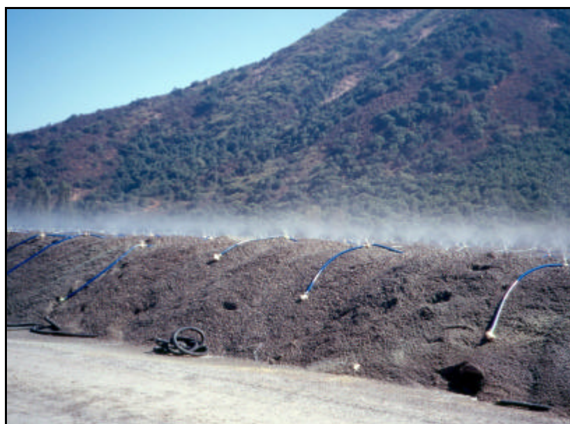
Fig. 12. Operación de lixiviación en pila. Mina "El Soldado" (Chile).
