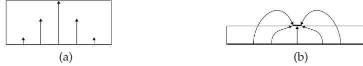
Figura 2.15: Perfiles del modo TE_{10} del campo eléctrico (a) en una guía de onda rectangular (b) en una línea microstrip.
