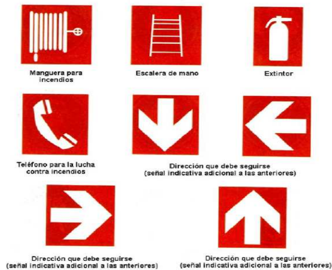
Figura 5.11. Señales lucha contra incendios
