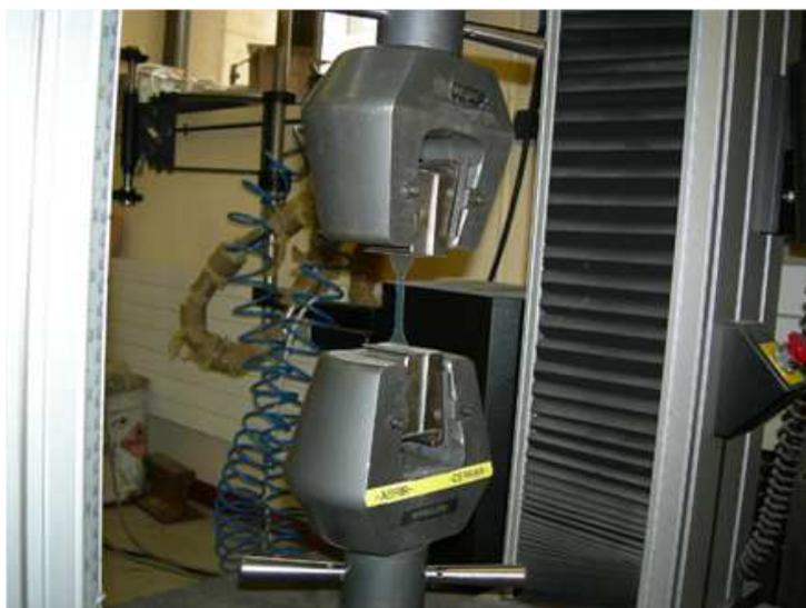
Imagen 70. Posicionamiento de la probeta en las mordazas.
