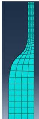
Imagen 149. Malla de la probeta.
