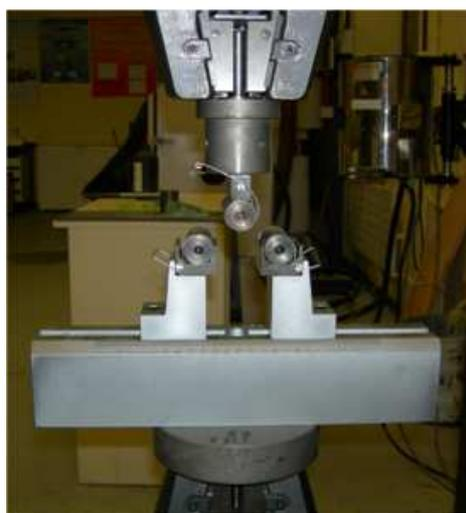
Imagen 84. Detalle del dispositivo para el ensayo de flexión a 3 puntos.
