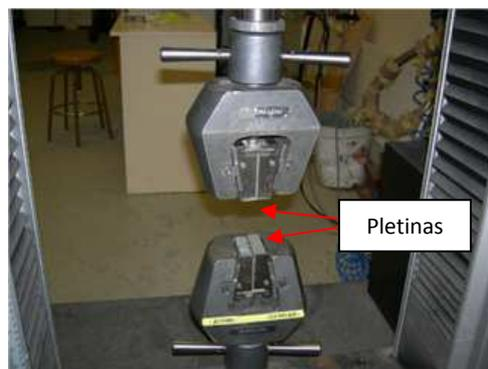
Imagen 68. Detalle de las mordazas de sujeción de las probetas.
