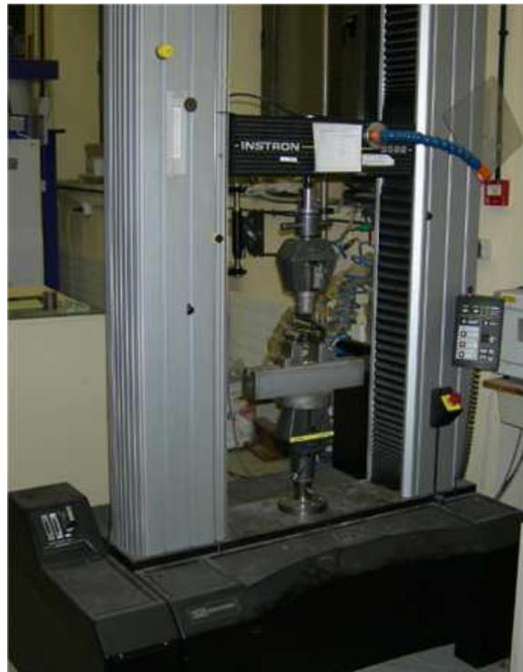
Imagen 83. Máquina empleada en los ensayos de flexión.
