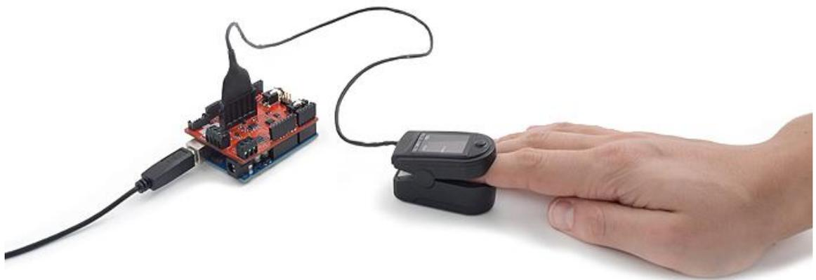
*Ilustración 5.8. Sensor oxígeno en sangre y pulsómetro.*
