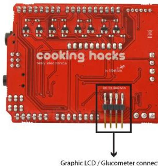
*Ilustración 5.5. Vista trasera con la conexión del Glucómetro*
