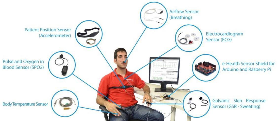
*Ilustración 5.3. Conexión de todos los sensores al paciente.*
