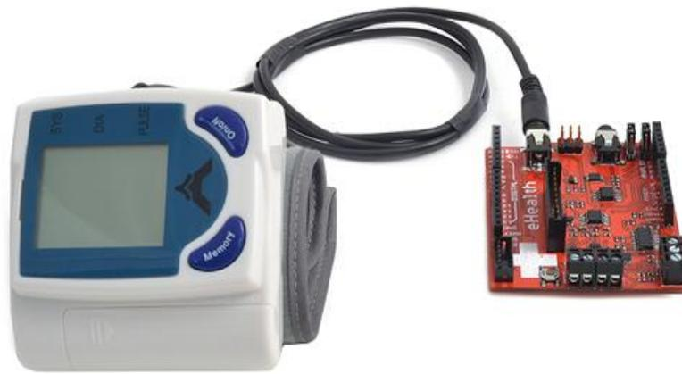
***Ilustración 5.13. Tensiómetro conectado a la plataforma E-Health***
