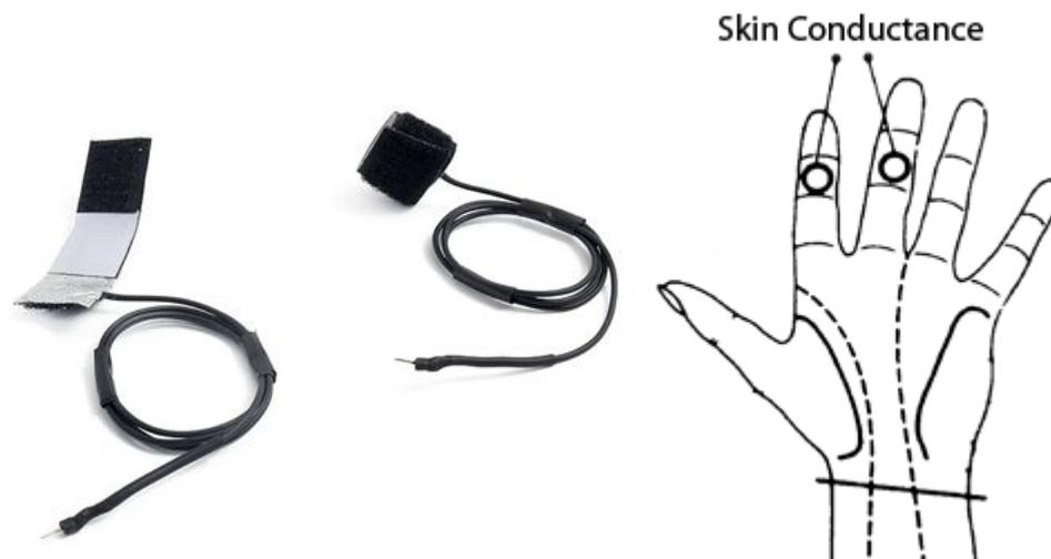
*Ilustración 5.15. Sensor GSR y su colocación.*
