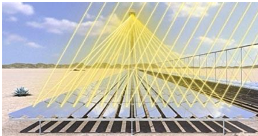
Ilustración 4: Mecanismo de concentración de una termosolar Fresnel
