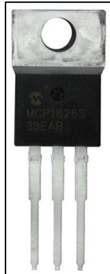
Figura 3.12. Regulador de tensión
