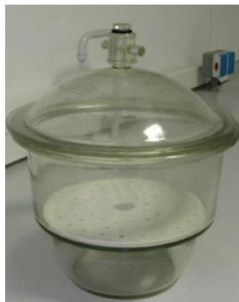
**Figura 11. Desecador de laboratorio. (Fuente: [www.ugr.es](http://www.ugr.es))**
