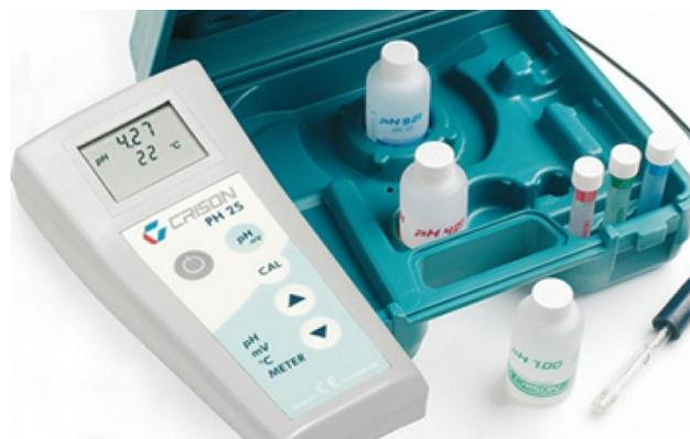
**Figura 13. pH-metro portátil y soluciones de calibración. (Fuente: [www.agroterra.com](http://www.agroterra.com))**
