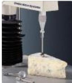
**Figura 10. Sonda esférica (Fuente: Stable Micro Systems)**
