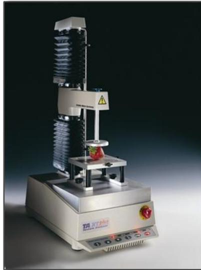
**Figura 9. Analizador TA.XTplus (Fuente: Stable Micro Systems)**
