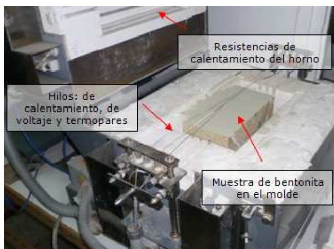
Figura 4: Disposición interior del horno, con elementos de medida y muestra.
