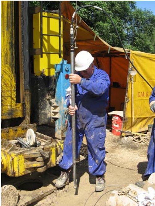
Sonda Caliper utilizada para registrar el diámetro de perforación.
