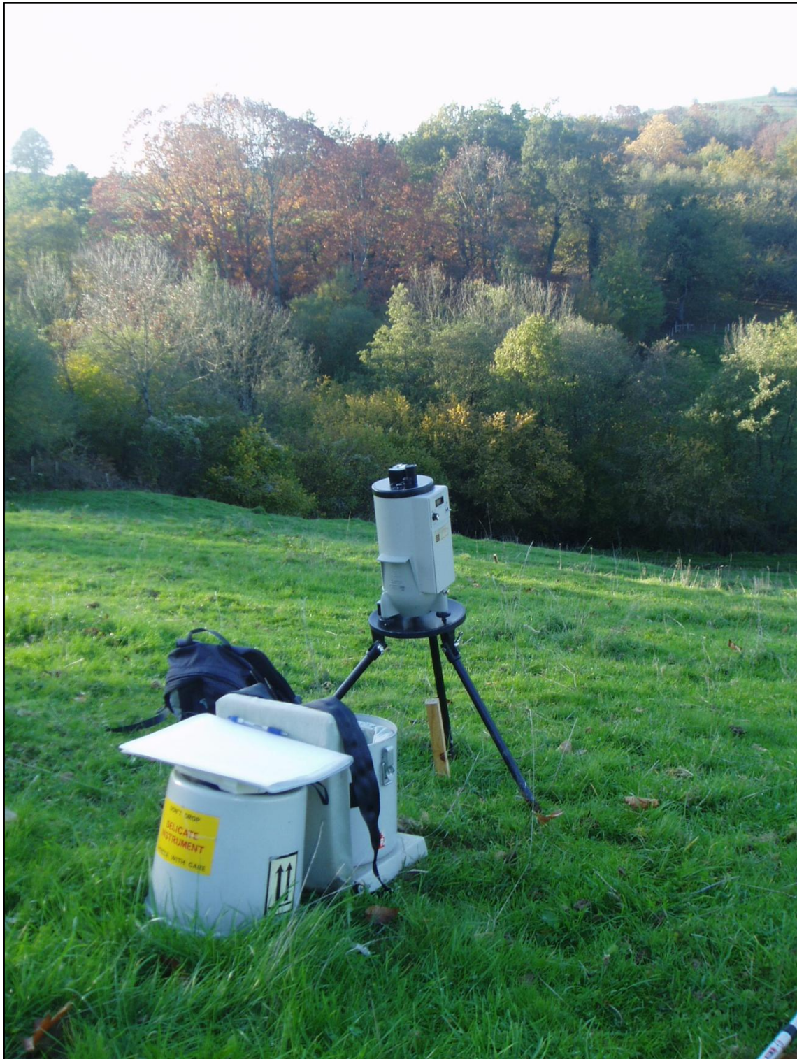
Foto 2.- Vista de la estación de medida 130 en dirección NO hacía las primeras estaciones del perfil P1, realizada después de tomar la medida gravimétrica. Tomada el 16/11/2012.
