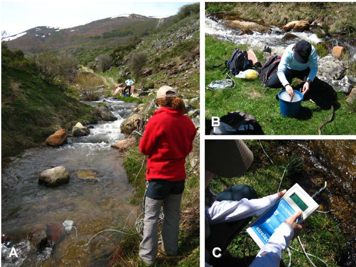
Figura 7. A. Realización de un aforo en el arroyo de Alcedo; B. Preparación del trazador salino; C. medición mediante el dispositivo Salino MADD.
