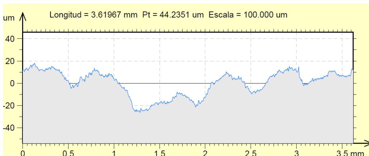
Figura 5.33. Perfil de la probeta tras el tratamiento SSP.
