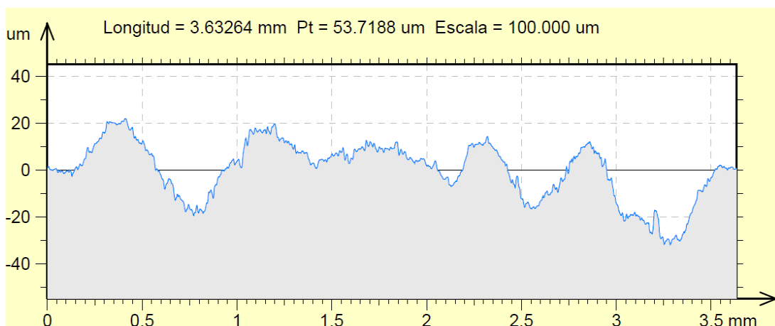
Figura 5.32. Perfil de la probeta tras el tratamiento CSP.
