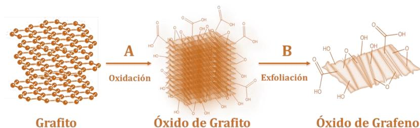
**Figura 1.2.1.** Preparación de óxido de grafeno a partir de grafito.
