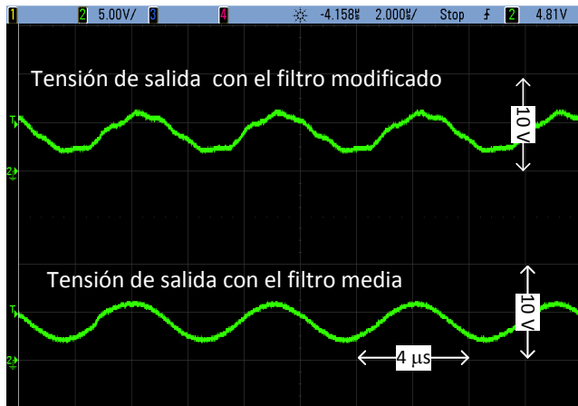
Figura 6: Tensión de salida reproduciendo un tono de 200 kHz
