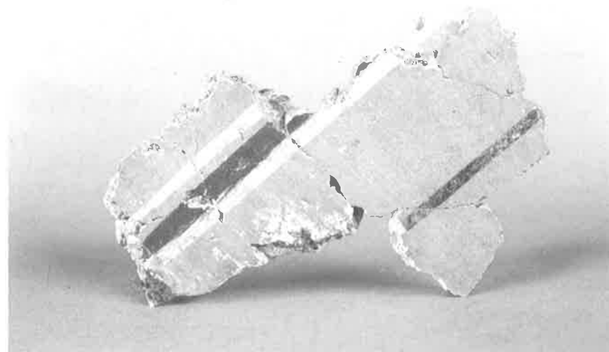
Fig. 4 — Estuco procedente del castro del Chao Samartín. Se trata de un apresto seco de temple y pintura a la cal sobre enlucido de cal. Lo interesante de este documento es su contexto cronológico-cultural ya que procede de un castro con una cronología del siglo I d.C.
