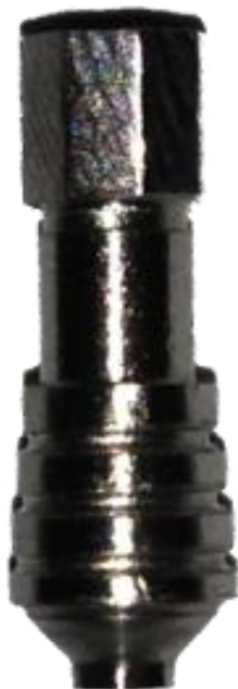
Figura 82. Fotografía de la pieza fabricada definitiva tornillo broca.
