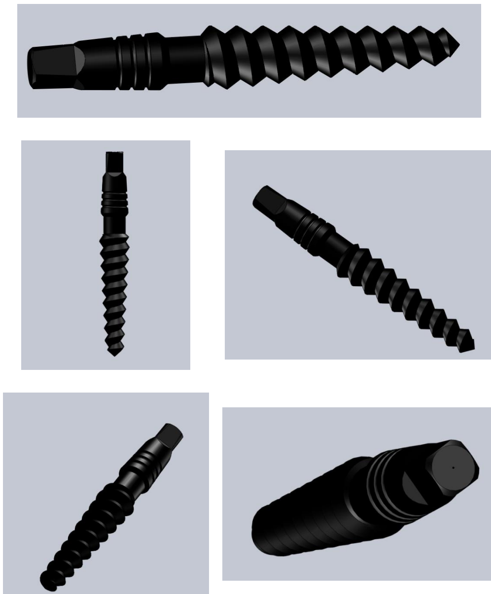
Figura 24. Diseño de la propuesta de microtornillo inicial en SolidWorks.
