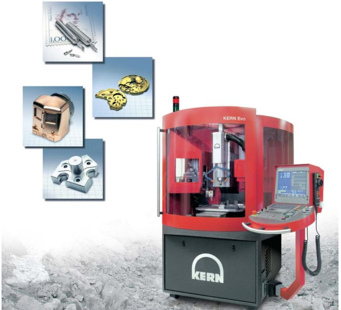
Figura 86. Kern Evo Ultra Precisión CNC Machinig Centre.
