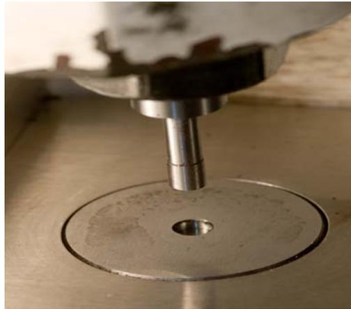
**Figura 3.12.** Detalle del troquel y disco de la peletizadora de laboratorio.
