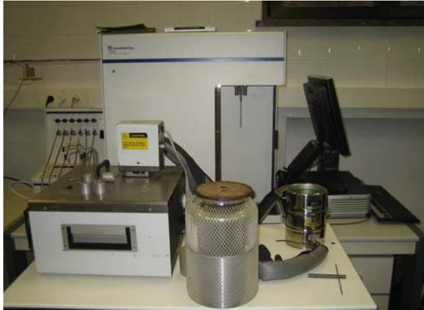
**Figura 2.7.** Equipo empleado para la obtención de las isotermas de N<sub>2</sub> a -196 °C y de CO<sub>2</sub> a 0 °C.
