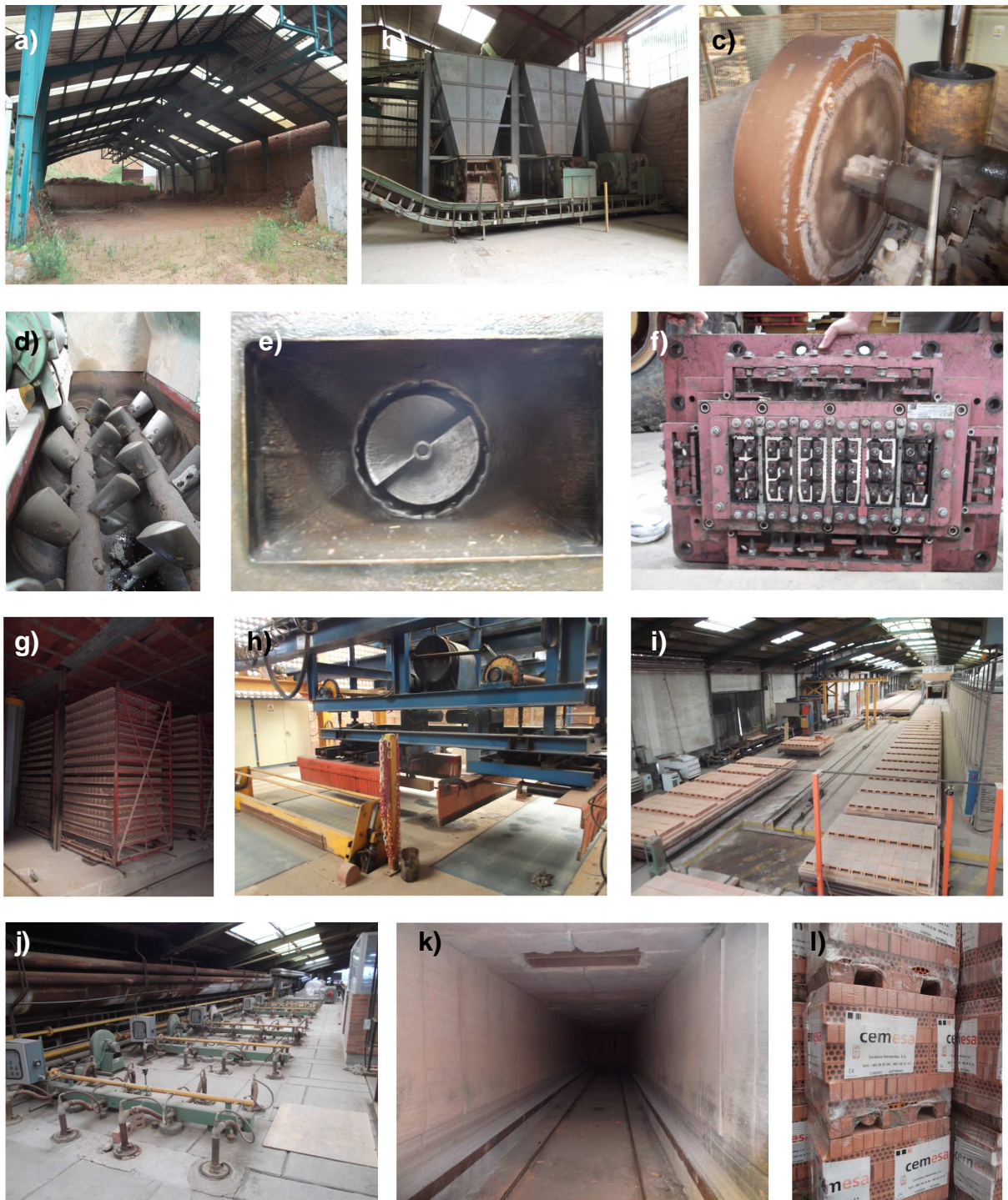
Figura 5.4 - Proceso de fabricación de ladrillos de Cerámica Menéndez, S.A. (Cemesa): a) Pudridero. b) Tolvas de mezclado de arcilla. c) Molino. d) Amasadora. e) Galletera extrusionadora. f) Cabeza extrusionadora intercambiable. g) Bandeja de ladrillos para su secado. h) Maquinaria automática de colocación de ladrillos previos a su cocción. i) Vagonetas de cocción. j) Quemadores de la zona de cocción. k) Interior del horno de cocción. l) Producto final paletizado.
