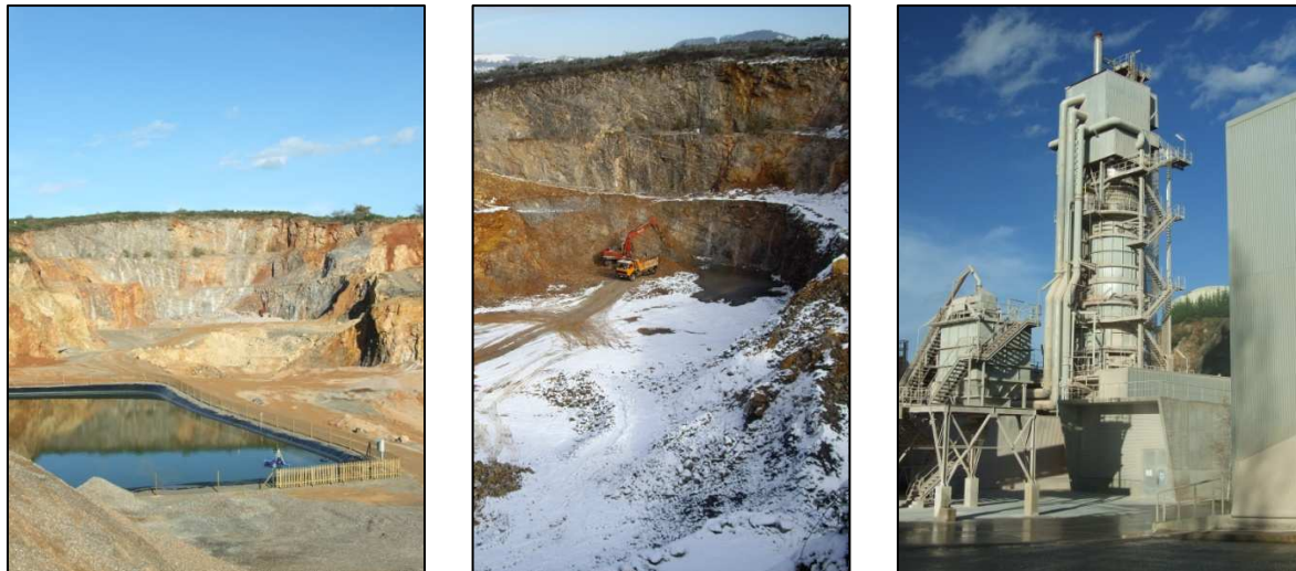
Fotografía 4.55, 4.56 y 4.57 - Mina Paula (o Caleras Asturianas, nº 122). a) Frente principal y balsa de recogida de aguas. b) Labores de extracción de dolomías, en tonalidad ocre, y calizas. c) Horno de calcinación para la fabricación de cal dolomítica.
