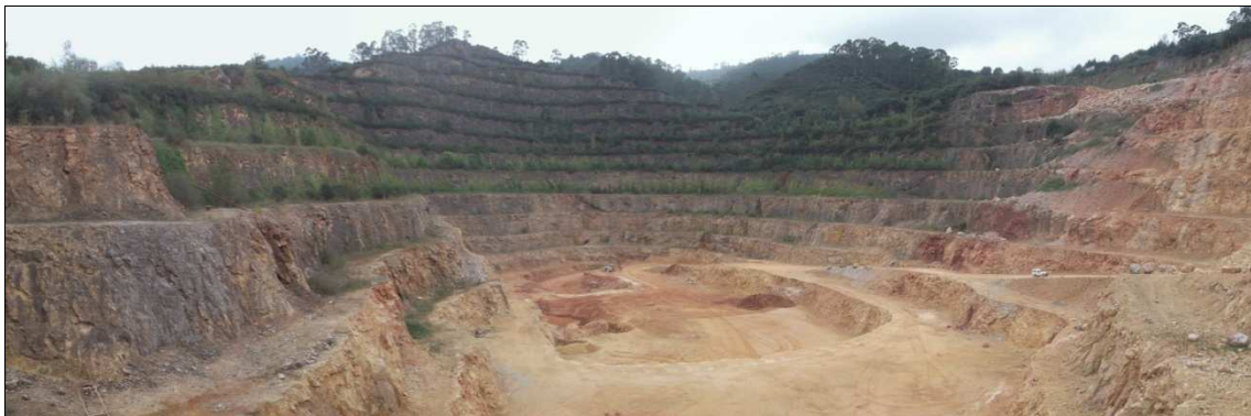
Fotografía 4.54 - Vista general del frente "Cuarteles" de la Cantera del Naranco (nº 201), donde se beneficia dolomía para su utilización como fundente en siderurgia.
