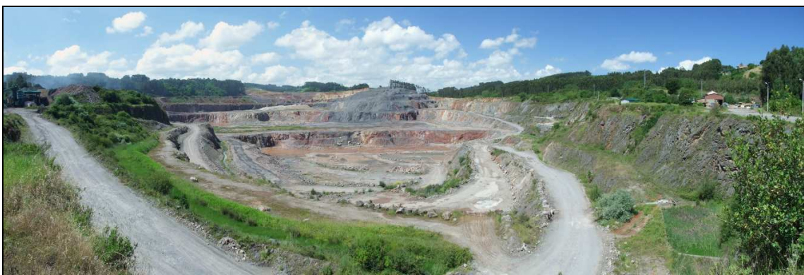
Fotografía 3.4 - Cantera Percil” (nº 34) de Sociedad Anónima Tudela Veguín en las cercanías de la localidad de Perlora. La caliza de la Fm. Barcaliente forma un sinclinal en cuyo núcleo aparecen pizarras de la Fm. San Emiliano (Mb. Pinos). El destino principal de ambos materiales es la fabricación de cementos, aunque, en menor medida, ha sido utilizada como áridos en recientes obras de infraestructura (Puerto de El Musel).
