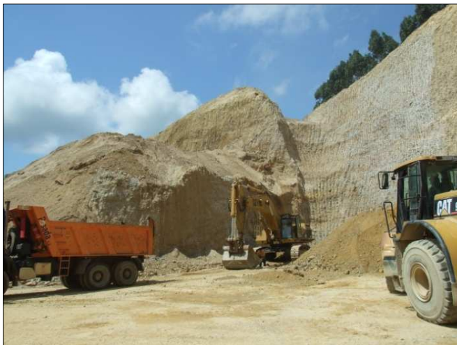
Fotografía 4.39 y 4.40 - Dos vistas de la explotación Marián (n° 14), donde se combina el beneficio de los conglomerados y arenas con el de las arcillas y arcillas caoliníferas.
