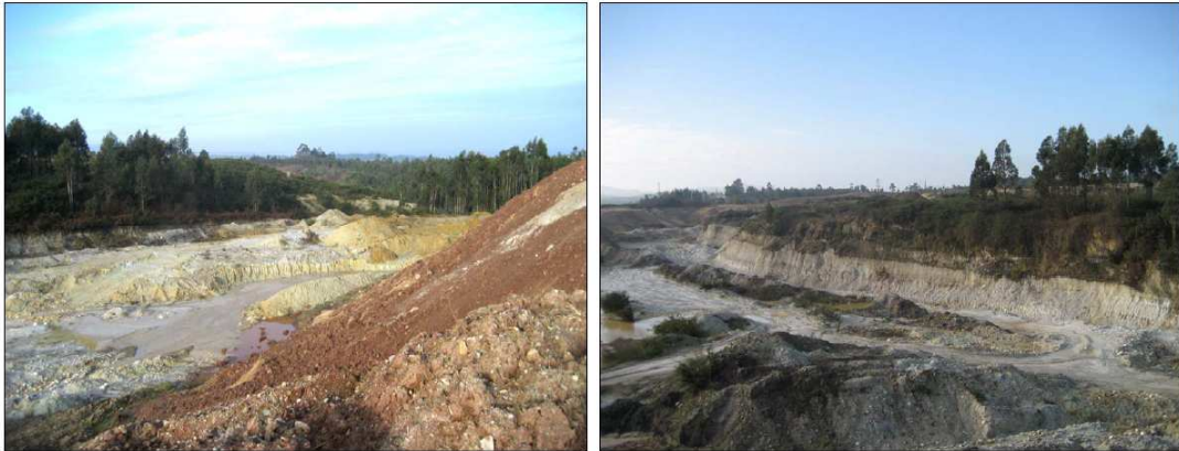
Fotografía 4.39 y 4.40 - Dos vistas de la explotación Marián (n° 14), donde se combina el beneficio de los conglomerados y arenas con el de las arcillas y arcillas caoliníferas.
