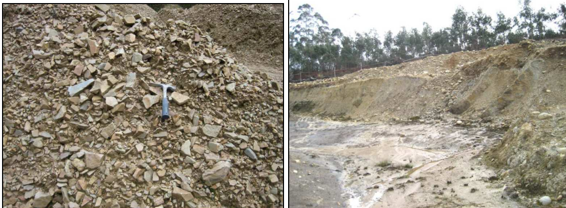
Fotografía 4.33 - Depósitos de rasa en la explotación Marián (nº 14). Fotografía 4.34 - Acopio de material procedente del beneficio de coluviones.
