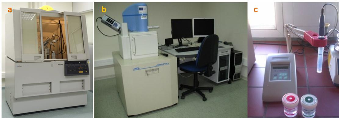
Figura 2.3: Equipos utilizados. a) Difractómetro de polvo de rayos X Philips X'PertPro, b) Microscopio JEOL-6610LV con microanálisis EDX incorporado INCA Energy 200. c) pH-metro CRISON BASIC 20. (Fuente de las imágenes a y b: Servicio Científico Técnico de la Universidad de Oviedo).
