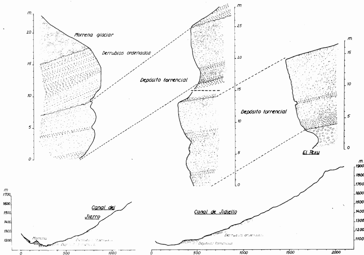
Fig. 4 Cortes estratigráficos en los depósitos cementados de las canales del Jierro y Jidiello y de las invernales de El Texu. Aparece señalada la correlación lateral de las diferentes facies. Para mayor detalle, léase la descripción en el texto.
