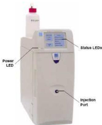
**Figura 21.** Panel frontal del ICS-1000, con el puerto de inyección por dónde se inyecta las muestras.
