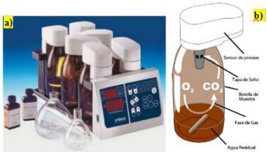
Figura 19. a) Equipo de medición de la DBO5; b) Ejemplo de funcionamiento de un frasco de medición de DBO con muestra de agua residual.
