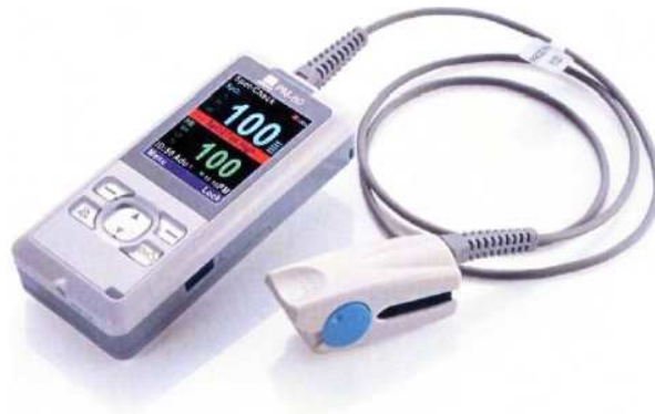
Figura 22. Imagen de un pulsioxímetro similar al que dispone el personal de la UME.
