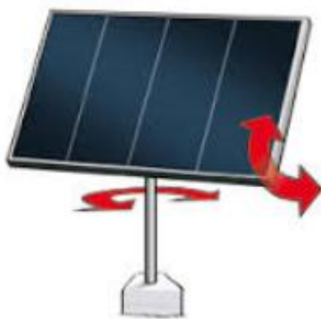
Imagen 5: Seguidor solar de dos ejes
