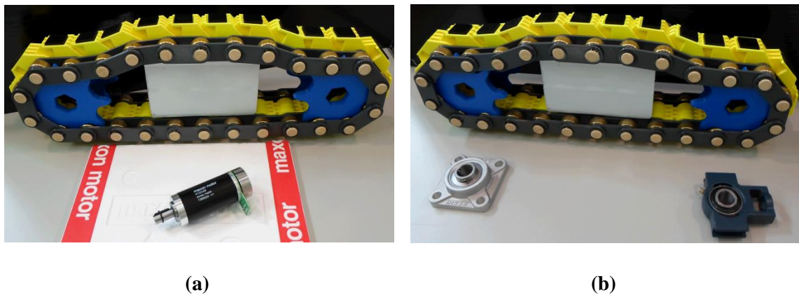
Figura 94. Elementos del prototipo del mecanismo: (a) motor; (b) soportes de los rodamientos de los ejes de transmisión.
