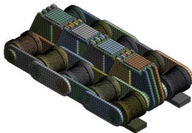
Figura 57. Malla de elementos finitos del modelo de los eslabones de apoyo.
