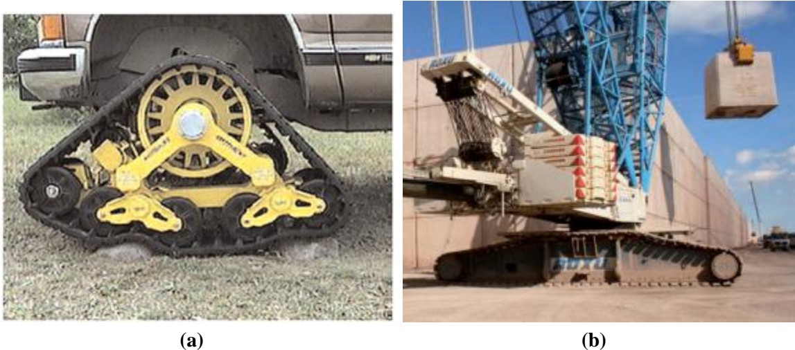
Figura 9. Orugas de tracción: (a) adaptación a superficies irregulares; (b) ejemplo de soporte de grandes cargas.
