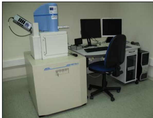
Figura 3: Microscopio Electrónico de Barrido (MEB) con cañón de electrones de filamento de wolframio modelo MEB JEOL-6610LV
