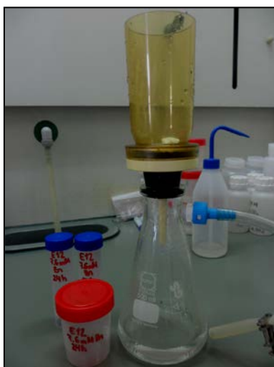
Figura 1: Equipo de filtración conectado a una bomba de vacío con filtro de 0.45μm
