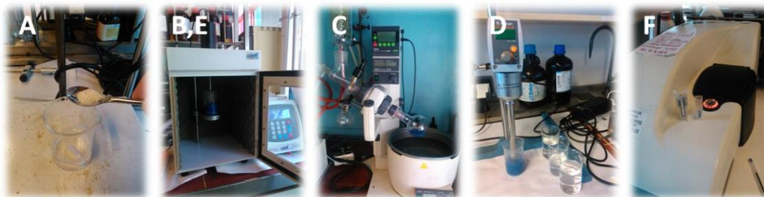
**Fig. 21.** Proceso de síntesis de los transfersomas: (a) pesado de componentes, agitación y adición de colorante; (b) sonicación de la disolución; (c) eliminación de solventes orgánicos mediante evaporación en atmósfera reducida; (d) rehidratación, adición extra de colorante y agitación mecánica; (e) nueva sonicación con medición de tamaño y polidispersión (f) mediante DLS. Consultar material y métodos para conocer condiciones exactas de trabajo y equipos empleados.
