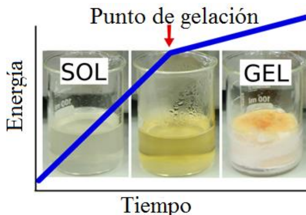
Figura 3.4. Determinación del punto de gelificación a partir de la medición de energía consumida frente al tiempo [3].
