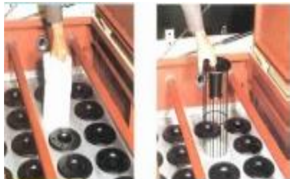
Colocación de mangas, jaula y venturi
