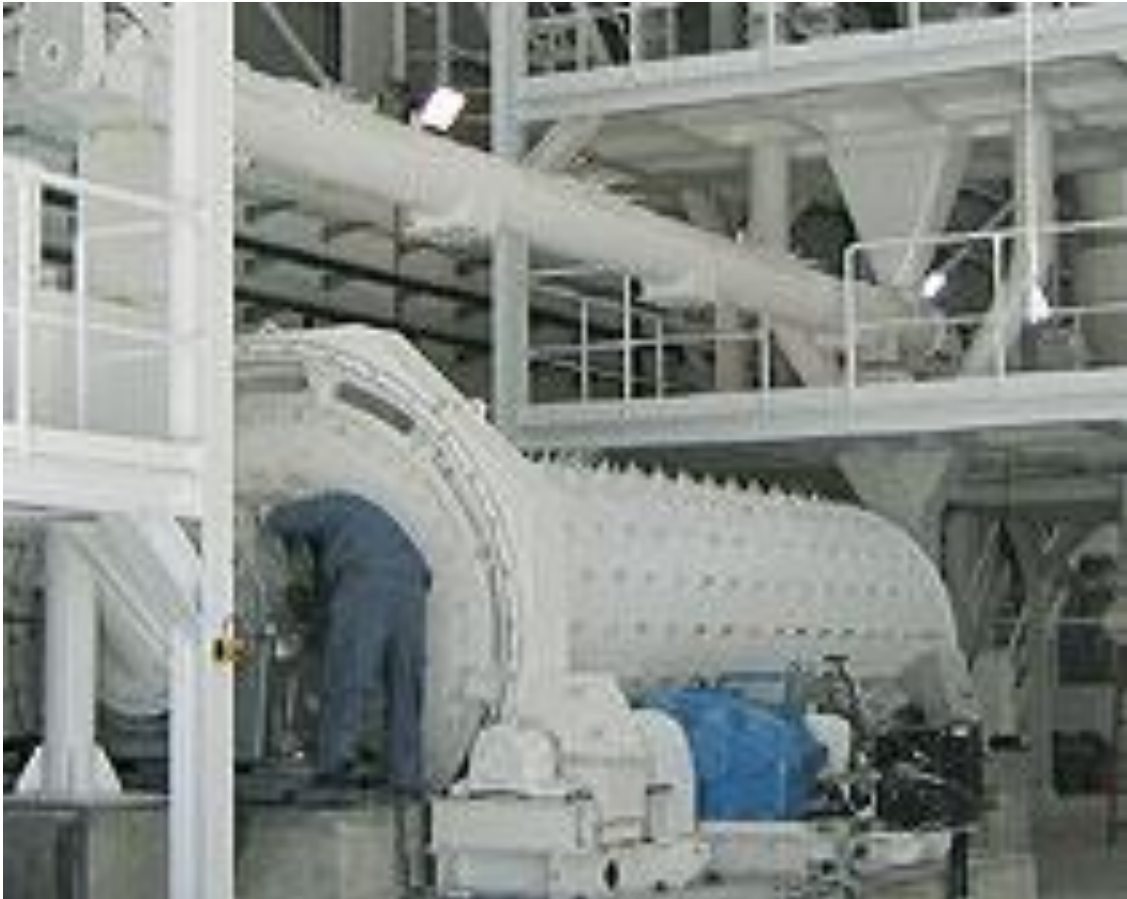
Molino ANIVI cilíndrico de bolas con evacuación neumática
