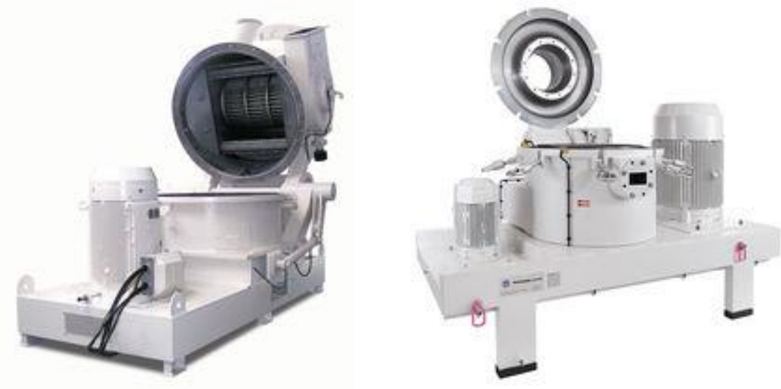
Ejemplos de molinos de eje vertical con plato, uno con clasificador incorporado en la tapa y el otro con preclasificador en el mismo eje.
