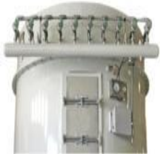
Filtros de mangas prismático y circular
