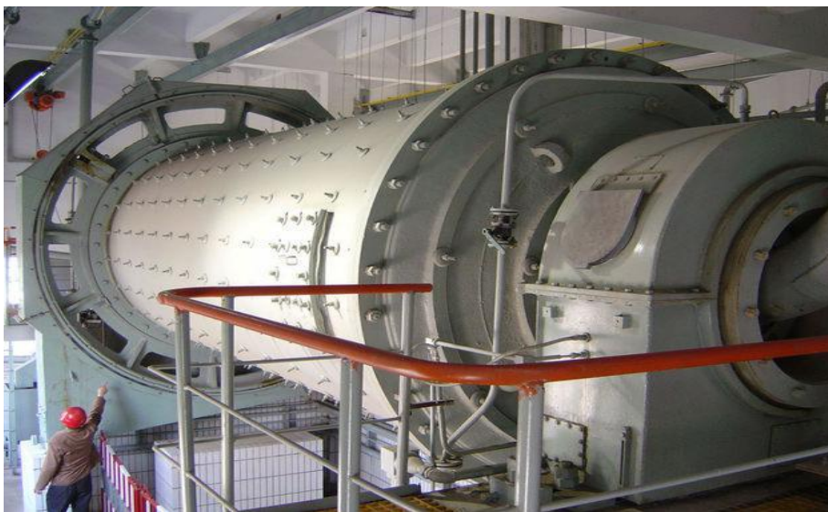
Molino de bolas de 750 kW.
