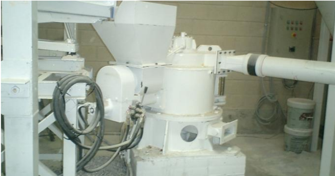
Modelo TH 50, con accionamiento hidráulico del sin-fin de alimentación.
