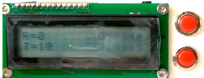
**Ilustración 95 (A.4): Indicador de posición y velocidad**
