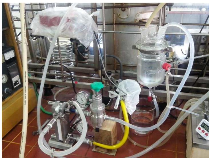
**Figura 17.** Dispositivo experimental para el trabajo con membranas
