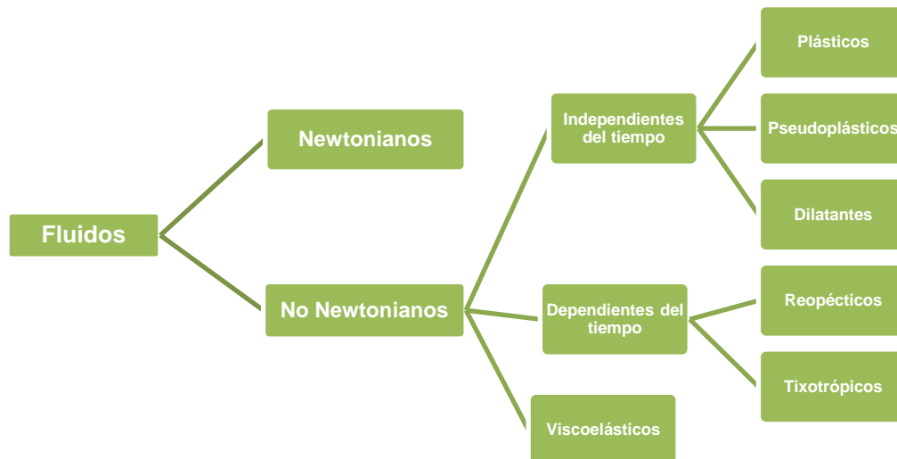
Figura 7: Clasificación de los fluidos en función de su comportamiento reológico (adaptado Marin et al., 2014).
